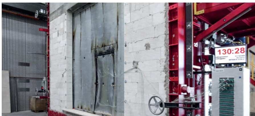
Тест за пожароустойчивост, показващ състоянието на изпитвания продукт след 130 мин.
