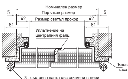
Хоризонтален разрез, 2-крила
