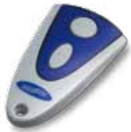
Дистанционно управление Mini-Novotron 502 2-канален, 433 MHz, KeeLoq-сменяем код
