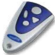
Дистанционно управление Mini-Novotron 504 4-канален, 433 MHz, KeeLoq-сменяем код
