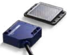
Рефлекторна светлинна бариера Extra 628 • 24-240 V AC, 12-240 V DC, IP 54 • обхват 5 m • използваема само като импулсен датчик
